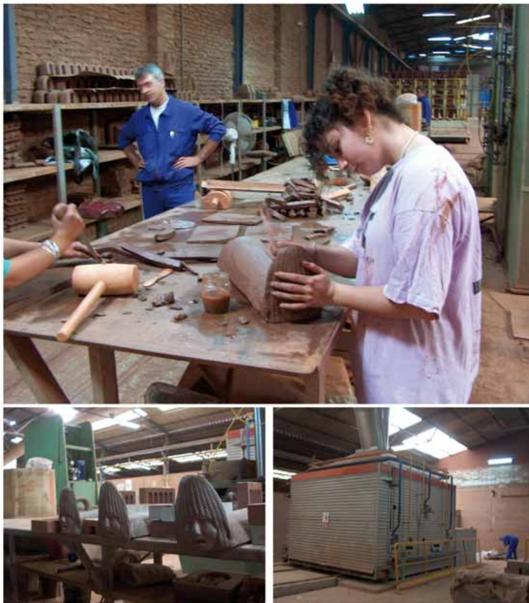
Figura 1. Elaboración de terracotas arquitectónicas en la Tejera Covadonga (Camargo, Cantabria)
