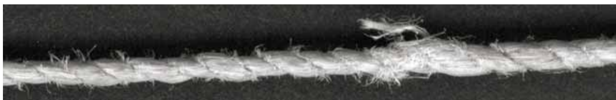
Figure 14. Etat de la cordelette usée au niveau latéral
