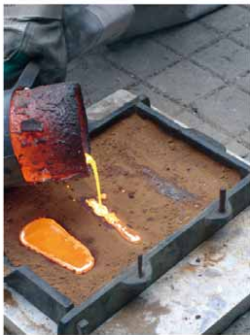
Figura 1. Vertido de cobre fundido y molde de arena
