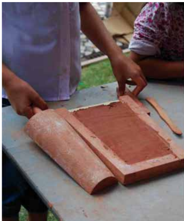
Figura 2. Molde trapezoidal y corneta que da forma curva al imbrex
