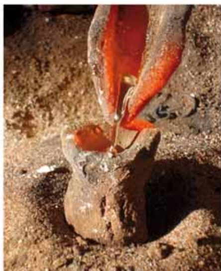
Figura 1. Imágenes que ilustran el proceso experimental de fundición de cascabeles por Raul Ybarra usando un fuelle de boca, diseños elaborados en cera, moldes de barro, vertido del metal fundido al interior del molde y dos diseños de cascabeles transformados en plata. (Fotografía: Raul Ybarra)
